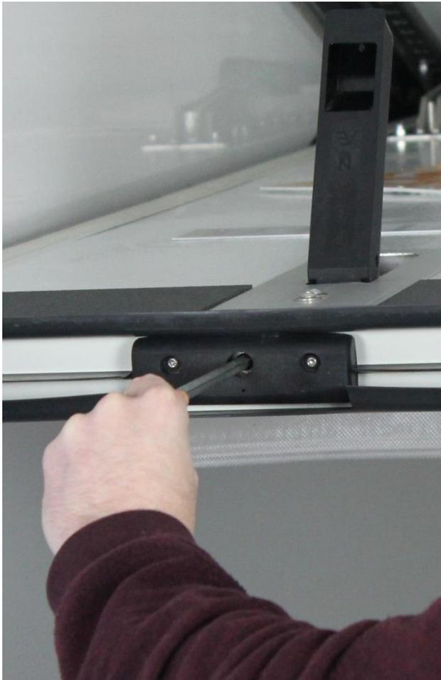
Stellen Sie die Bodenanschlüge bei Bedarf unten mithilfe eines Innensechskantschlüssels (10 mm) ein.
