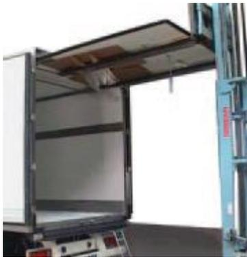
Heben Sie die komplette Frigowall mit einem Gabelstapler mit verlängerten Gabeln (mind. 1,85 m lang) oder anderen Hebezeugen an (z. B. einem Scherenhubwagen).
