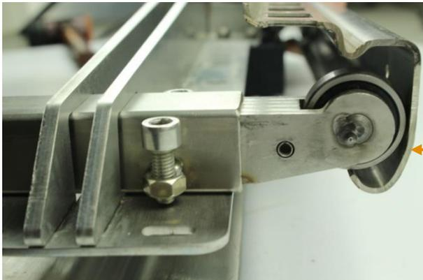
Stellen Sie das Rad so ein, dass es in der Frigowall-Schiene liegt wie in der Abbildung gezeigt.
