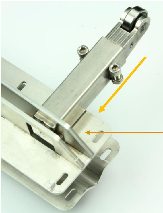
Insertar el tubo dentro del hueco que hay en el carro antes de colocar el Frigowall dentro del vehículo.
