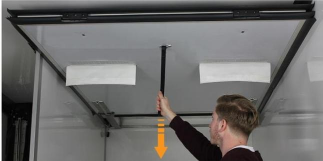
Cuidadosamente estire del separador hacia abajo unos 45° utilizando la cinta.
