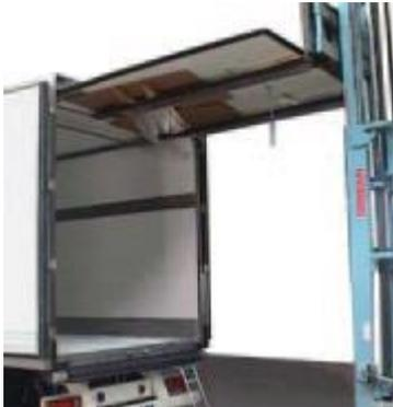
Utilice unas palas y/o extensores de mínimo 1,85 m de largo para elevar todo el Frigowall.
