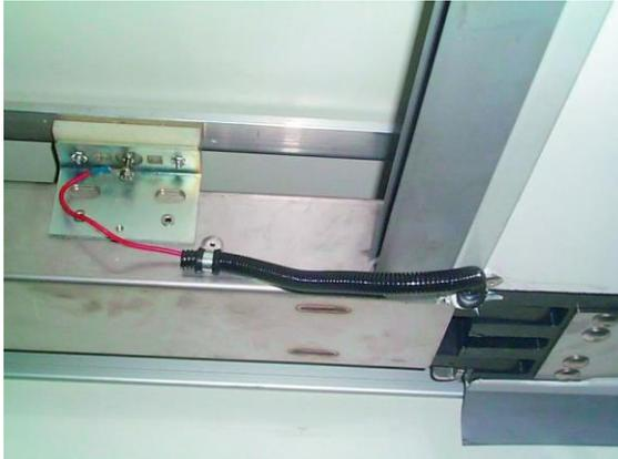
El deslizador debe instalarse en el carro, una vez se ha montado el separador en el vehículo.
