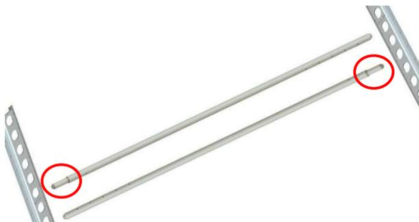
Die Rohre **müssen** in entgegengesetzter Richtung einbaut werden.
