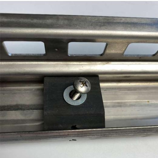
Montieren Sie den Gummistopper.
